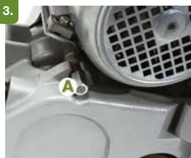
Lås fast motorn genom att skruva åt (A).
