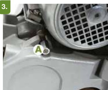
Fixez le moteur en serrant la vis (A) .
