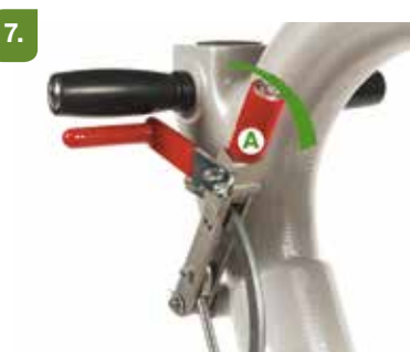
Levante el tambor con la palanca (A).
