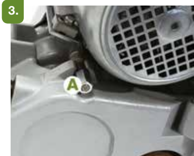
Durch Festziehen des Drehknaufs (A) den Motor sichern.
