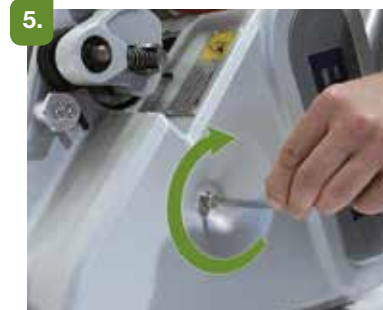
Die Riemenabdeckung schließen und die Schraube anziehen.
