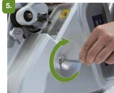
Chiudere il carter protezione cinghie serrando la relativa vite.
