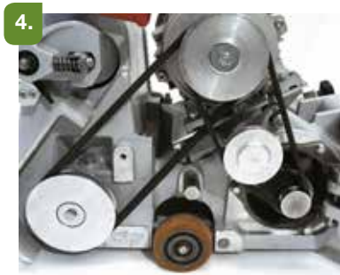
Positionnez et tendez les courroies.
