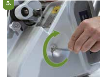
Cierre la protección de la correa y apriete el tornillo.
