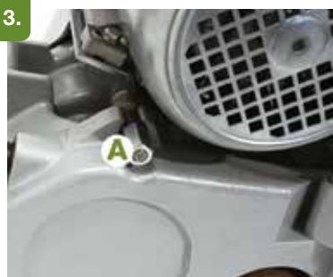
Fissare il motore, serrando la manopola (A).
