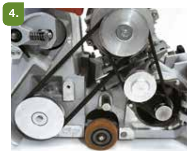
Montera och spänn remmarna.
