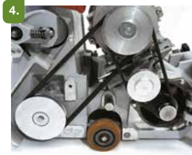
Die Riemen einlegen und spannen.
