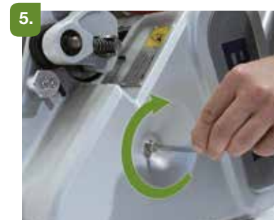
Stäng skyddskåpan och dra åt skruven.
