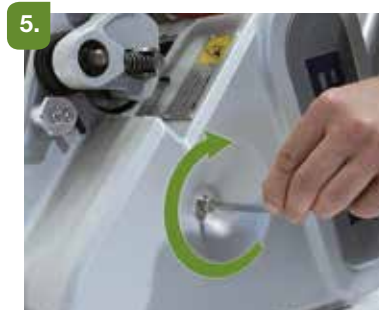
Fermez le cache de la courroie et serrez la vis.
