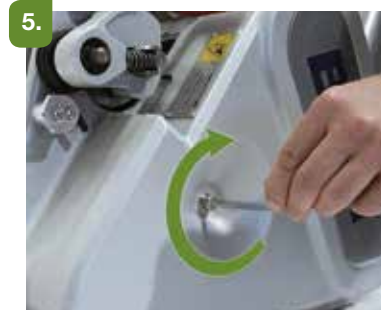
5. Feche a proteção da correia e aperte o parafuso.
