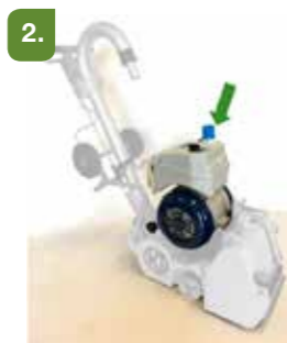
Den Motor in das Gehäuse einsetzen.
