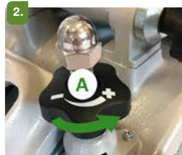
2. Drej justeringsknappen (A) mod uret for at øge tromletrykket mod gulvet.
