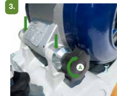
3. Zet de motor vast door de knop aan te draaien (A).
