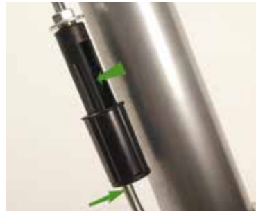
Montare il tubo di aspirazione (A) e l'astina comando rullo (B).
