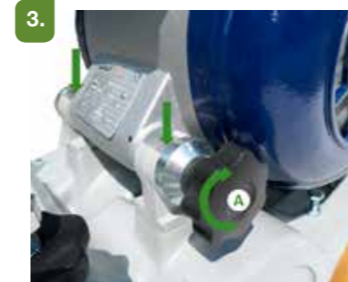
3. Fissare il motore serrando la manopola. (A).
