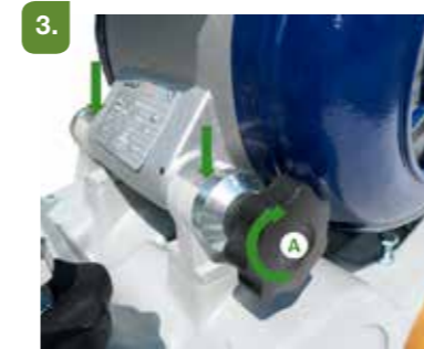
3. Закрепите двигатель, затянув ручку (A).
