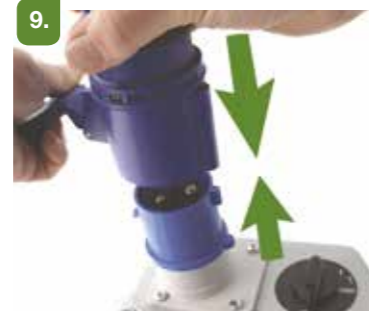
Collegare il cavo di alimentazione alla macchina ed alla linea elettrica.
