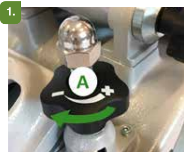
1. Drej justeringsknappen (A) med uret for at reducere tromletrykket mod gulvet.
