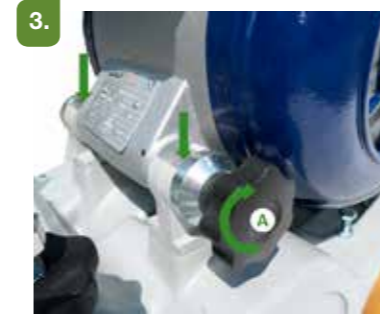
Fastgør motoren ved at stramme drejehjulet (A).
