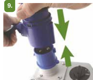
Branchez le câble d'alimentation à la machine et à l'alimentation.
