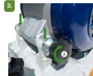
Durch Festziehen des Drehknaufts (A) den Motor sichern.
