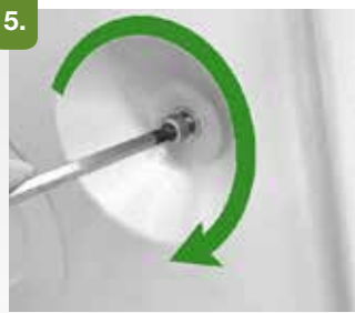
Die Riemenabdeckung schließen und die Schraube anziehen.
