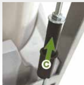
6. Nachdem der Knauf (A) gelöst und der Walzenhebel nach vorn (B) umgelegt wurde, die Hülse (C) anheben und den Stab (D) aus der Kupplung (E) lösen.
