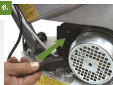
Anslut motorkontakten till uttaget på utsugningsenhetens överdel. Anslut anslutningskabeln mellan handtag och motor till uttaget på motorhusets sida.
