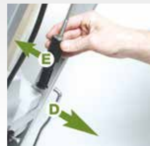
6. Nachdem der Knauf (A) gelöst und der Walzenhebel nach vorn (B) umgelegt wurde, die Hülse (C) anheben und den Stab (D) aus der Kupplung (E) lösen.
