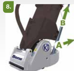
8. Den Griff leicht nach hinten ziehen (A) und vertikal anheben (B), um ihn aus dem Gehäuse zu entnehmen. Das Grundgestell mit einer Hand vorn am Bolzen des Walzenschutzes (A) und mit der anderen hinten am Tragegriff (B) anfassen und anheben.
