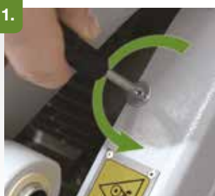
1. Abra la protección de la correa soltando los tornillos.
