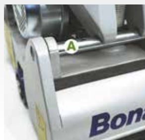
8. Den Griff leicht nach hinten ziehen (A) und vertikal anheben (B), um ihn aus dem Gehäuse zu entnehmen. Das Grundgestell mit einer Hand vorn am Bolzen des Walzenschutzes (A) und mit der anderen hinten am Tragegriff (B) anfassen und anheben.
