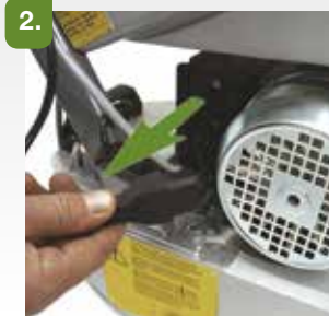
2. Das Motorkabel am Kopf der Absaugereinheit von der Steckdose am Grundgestell trennen.
