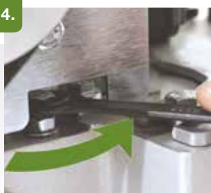
4. Al girar el tornillo de ajuste en sentido contrario al de las agujas del reloj el extremo del tambor de la parte del ventilador del motor se alejará del suelo.
