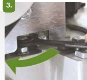
3. Al girar el tornillo de ajuste en el sentido de las agujas del reloj el extremo del tambor de la parte del ventilador del motor se acercará al suelo.
