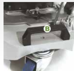
8. Den Griff leicht nach hinten ziehen (A) und vertikal anheben (B), um ihn aus dem Gehäuse zu entnehmen. Das Grundgestell mit einer Hand vorn am Bolzen des Walzenschutzes (A) und mit der anderen hinten am Tragegriff (B) anfassen und anheben.
