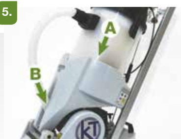
Sätt dit utsugningsenheten i korghållaren (A), (B).
