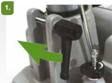
1. Infilare il tubo nella sua sede e serrare la maniglia.
