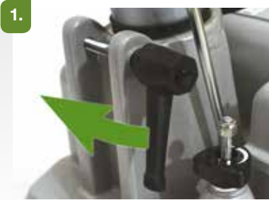
Das Rohr in das Gehäuse stecken und den Griff anziehen.
