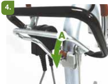
4. Levante el tambor con la palanca (A).
